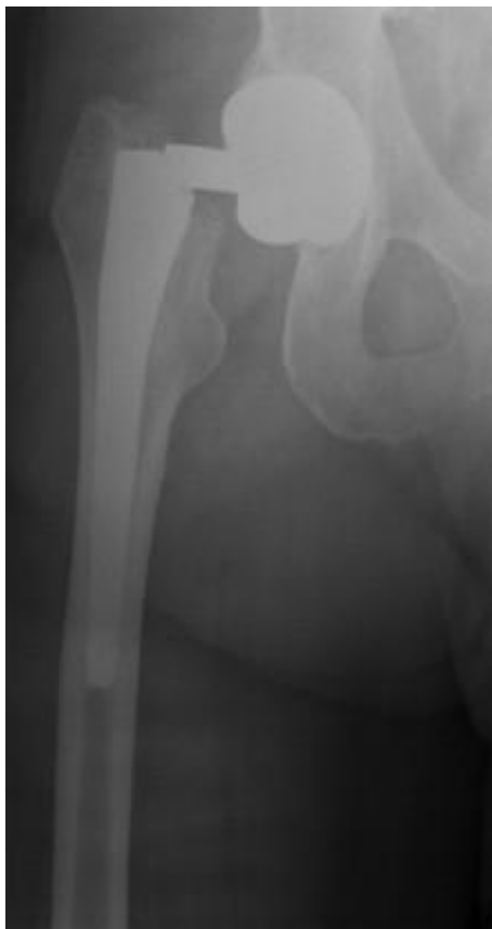
RTG zlomljenega modularnega vratu
